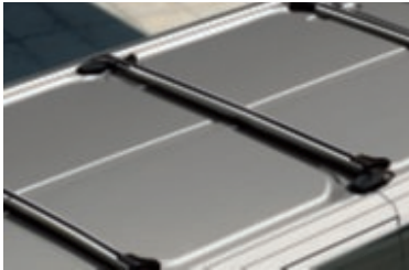
Integrovaný střešní nosič (výbava na přání)
